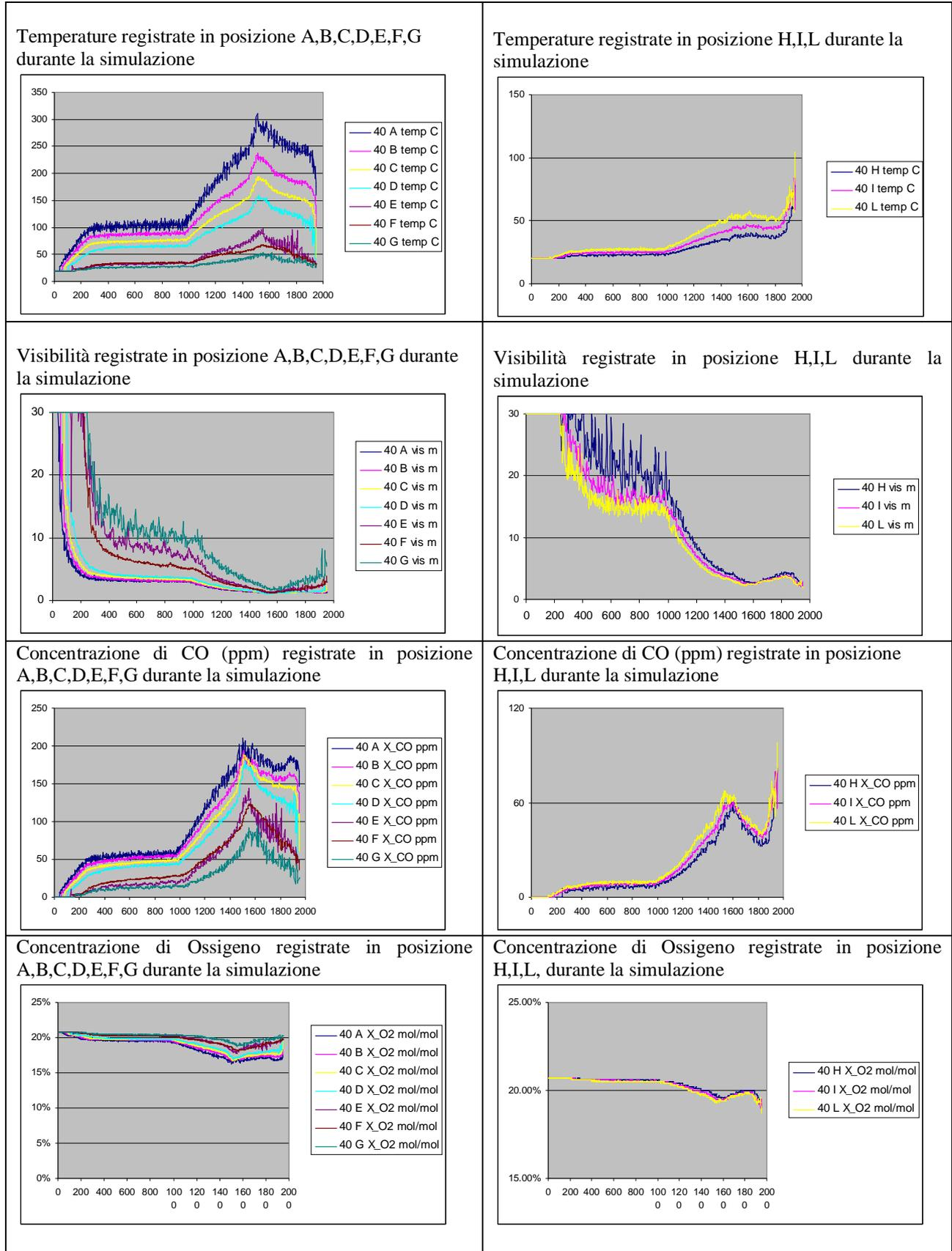
Dai risultati così ottenuti, si evince che, le concentrazioni di ossigeno e di monossido di carbonio si mantengono, per l'intera durata della simulazione, al di sotto delle soglie di accettabilità, in corrispondenza di tutte le posizioni monitorate.
