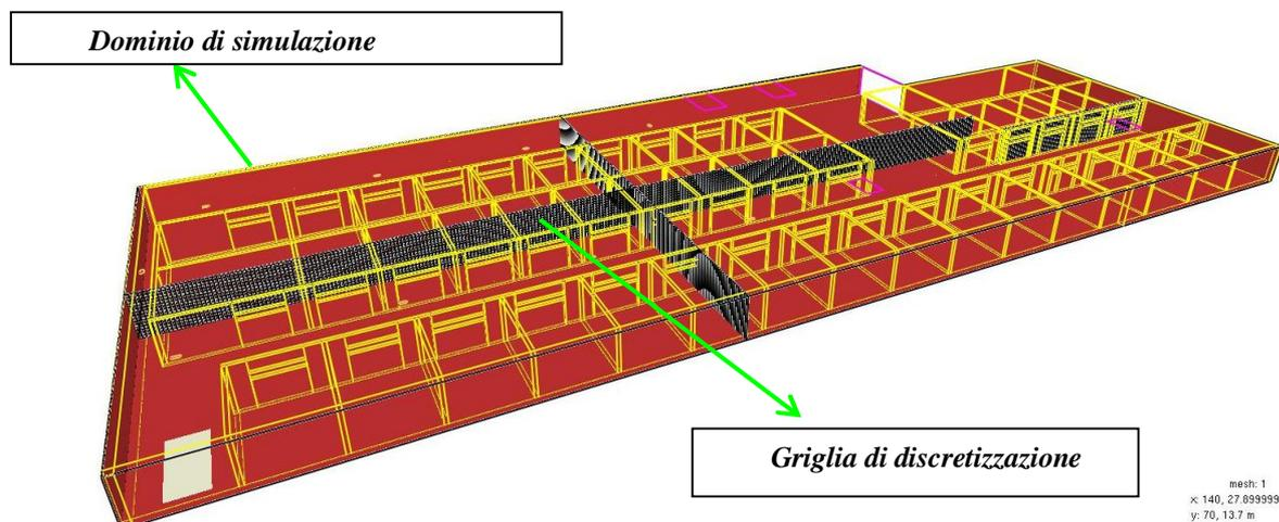
Fig. 5 – Dominio di simulazione e griglia di discretizzazione
